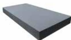
Pannello isolante in polistirene espanso sinterizzato di colore grigio, additivato con grafite, a lambda migliorato ( $\lambda$  0,031) tagliato da blocco, autoestinguento classe E.
